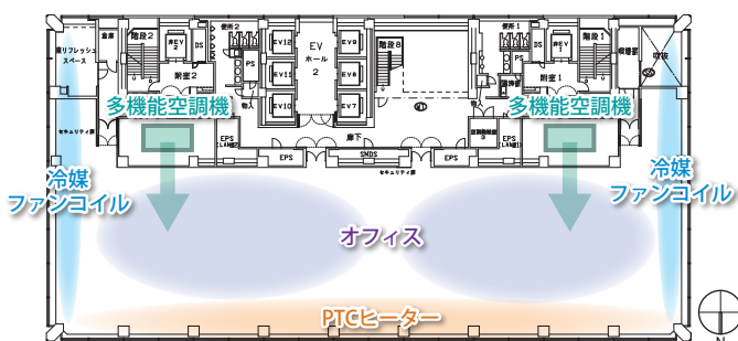
図4 基準階オフィスの空調ゾーニング図
