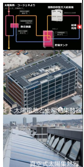
図1-1c 冷暖房熱源システム系統図
