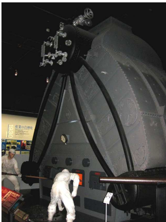
巡洋戦艦「金剛」搭載のヤーロー式ボイラー
