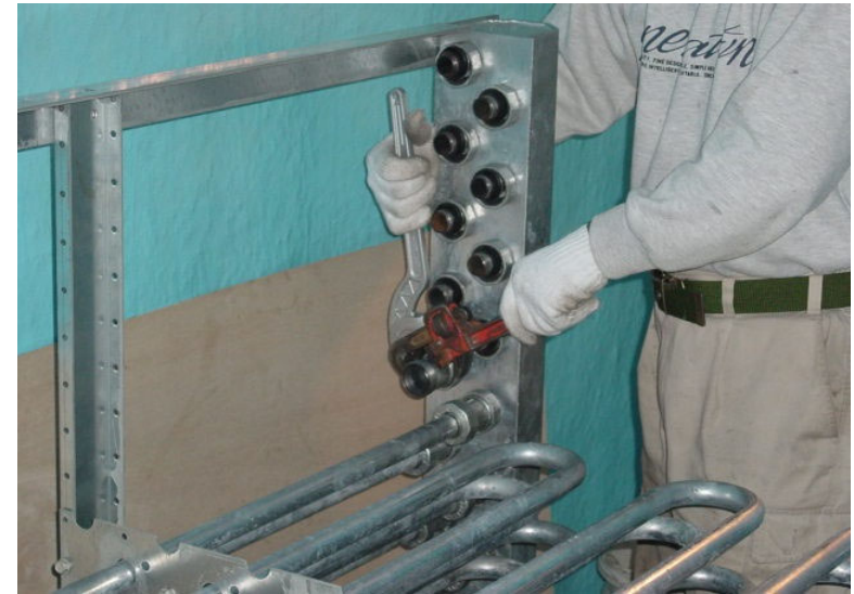
コイル組立て(ハイパワーロックジョイント)
