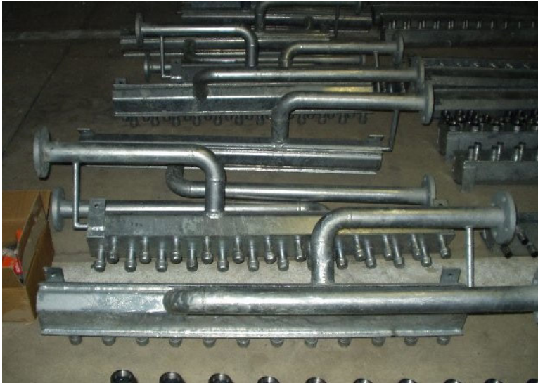
部材仮置き(ヘッダ部)
