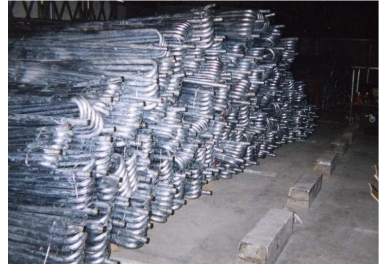
部材仮置き(コイルサーキット)
