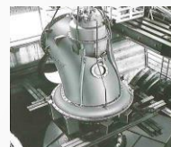
1968年 2,200mm立軸ポンプの 試験風景（第1機械工場）
