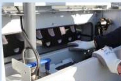
カバー付き散水槽 運転中でも槽内検査ができます
