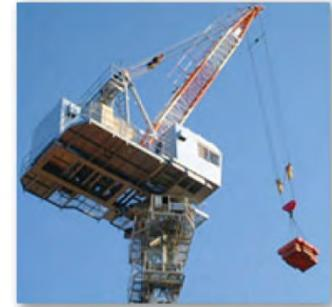
蓄電池を積んだハイブリッド型タワークレーンが開発されています。荷降ろし時にクレーンのモーターで発電し、その電力を蓄電池に貯めておき、その貯めた電力で荷揚げを行うものです。これにより、クレーンの電力使用量が少なくて済みます。
