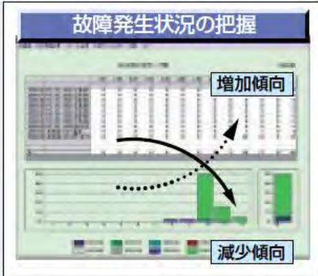
設備システムの警報発生状況の経年変化 (増加傾向、均衡状況、減少傾向) を分析し、点検/更新頻度等の判断を行います。
