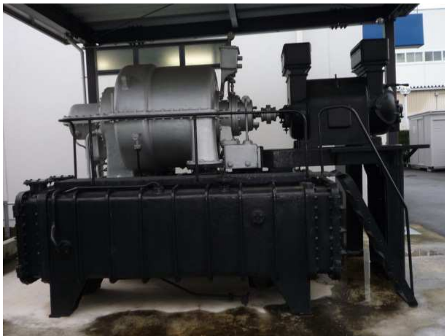
展示保管されている高砂荏原式ターボ冷凍機
