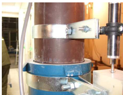
写真 10.3 排水管移動の実験例 (c) (立管 100A。層間変位 1/67 時)
