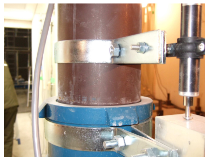
写真 10.3 排水管移動の実験例 (c) (立管 100A。層管変位 1/67 時)
