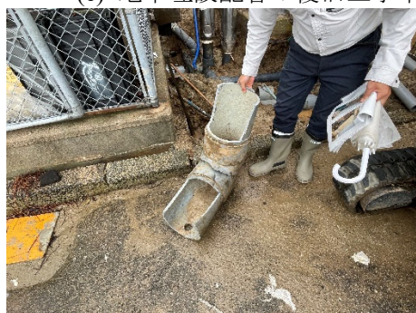
(g) 地中埋設管の破断箇所掘り出し後
