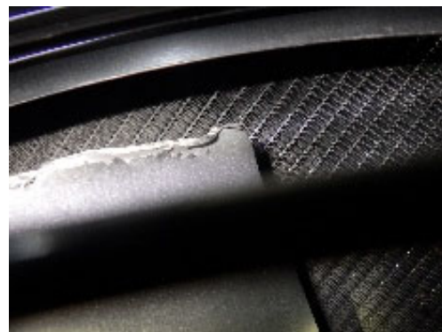
(d) 冷却ファン損傷
