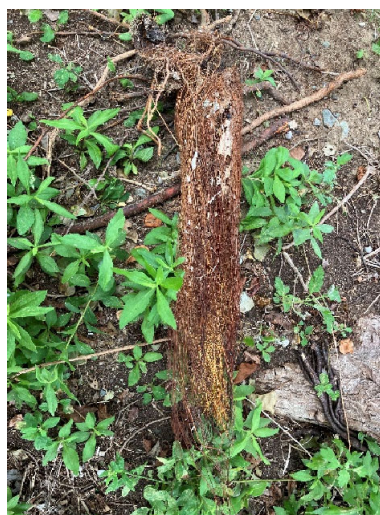
図 4.1.4 配管から取出した根 （建築物 A）
