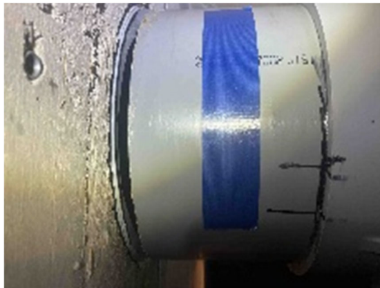
(c) 破断した循環ろ過配管
