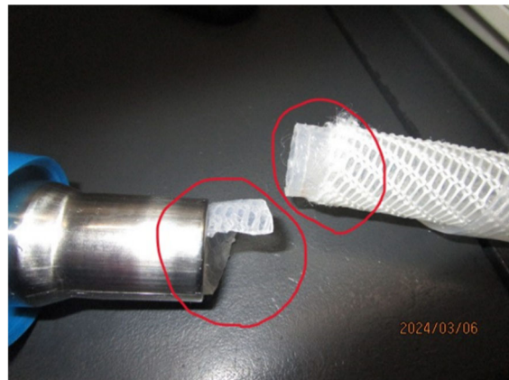
(b) 生産用水の配管破断
