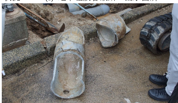
(h) 地中埋設管破断状況
