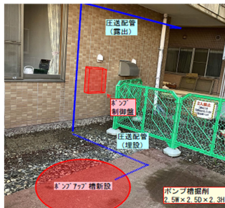
図 4.8.3 排水管の復旧計画
