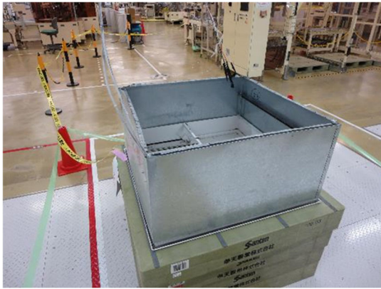
(a) 脱落した排煙口
