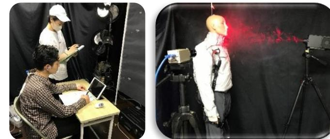
左の写真に示すような被験者実験や、右の写真にあるようにサーマルマネキンを用いています。この写真ではファン付き作業服の冷却効果に関する実験です。スモークを使って気流の可視化を試みています。
