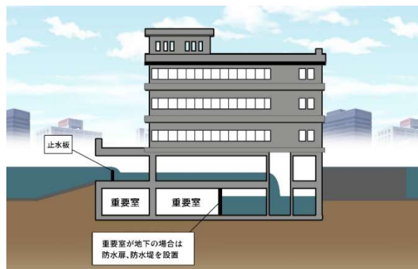
図-14 地下階重要室の水密区画・防水扉の設置
