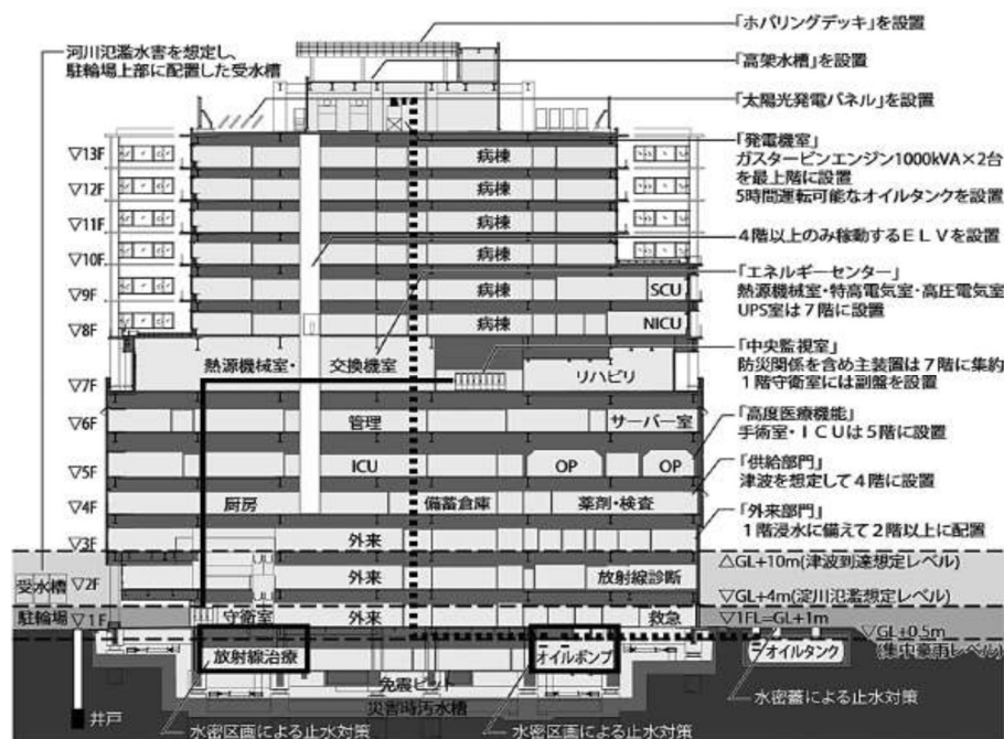
図-10 段階的な浸水対策
