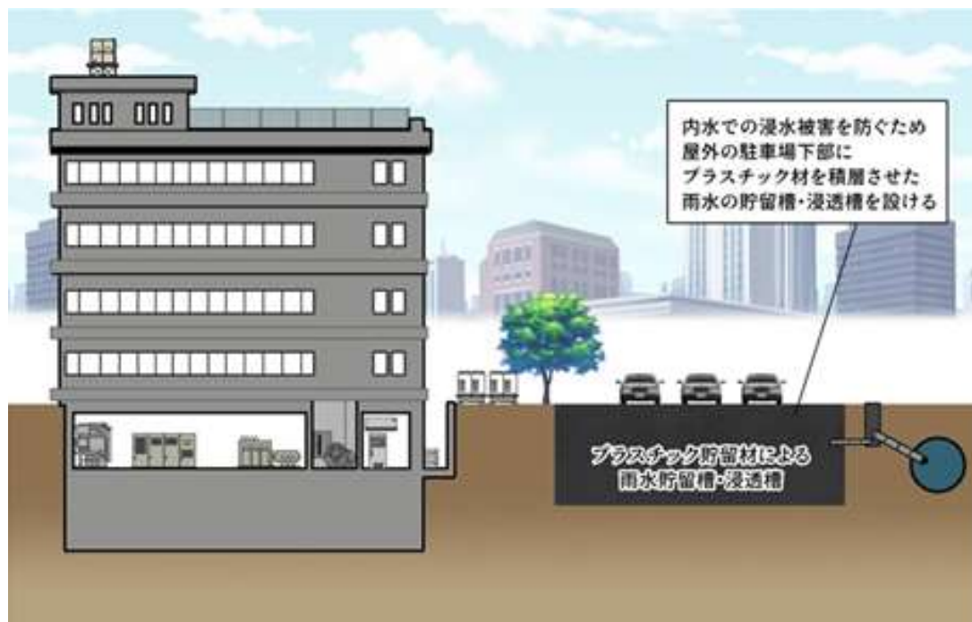
図-16 屋外駐車場下部に雨水貯留槽・浸透槽を設置
