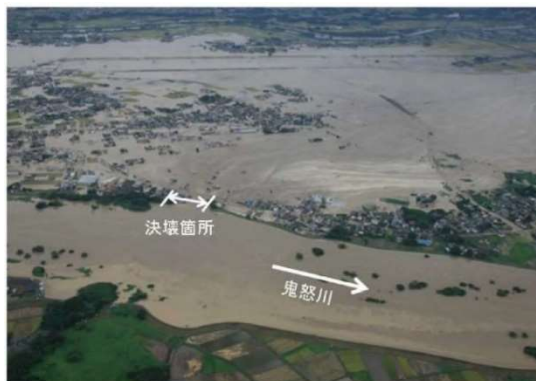
写真-26 鬼怒川の決壊状況（茨城県常総市三坂町地先） 出典：国土交通省「水害レポート2015 ( https://www.mlit.go.jp/river/pamphlet_jirei/pdf/suigai2015.pdf )
