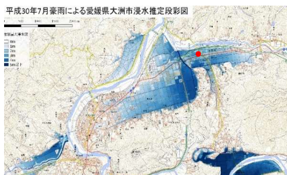
図-7 平成30年7月豪雨による愛媛県大洲市浸水推定段彩図
