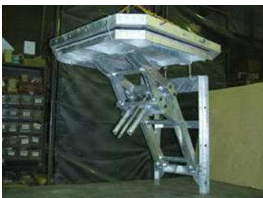
写真-32 浸水防止機 出典：J地下鉄施設 HP 風水害対策
