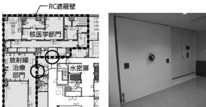
図-23(左), 写真-41(右) 水密区画と水密扉 出典：(一社)建築設備技術者協会「建築設備士(2017年10月号)」
