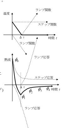
1) 先の 0) の連続関数の式に  $t = \Delta \tau$  を代入して、離散系の直角 $\triangle$ 波の熱応答 $\phi$  を得ます。 ( $A_0$  の項が消えます)
