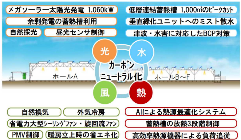
図-2 光・風・水・熱源の最適運用によるカーボンニュートラル化
