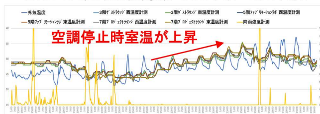
図16. 夏季休暇中の外気、室内温度と降雨量の経時変化
