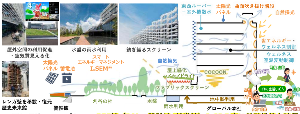
図1 環境コンセプト図 BPI値 (PAL*設計値/基準値) 0.63の高い外壁性能を確保
