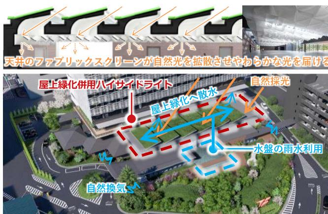
図4 屋上緑化併用ハイサイドライト・水盤の雨水利用
