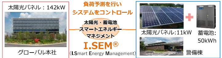
図18 太陽光・蓄電池スマートエネルギーマネジメント
