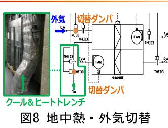
図8 地中熱・外気切替
