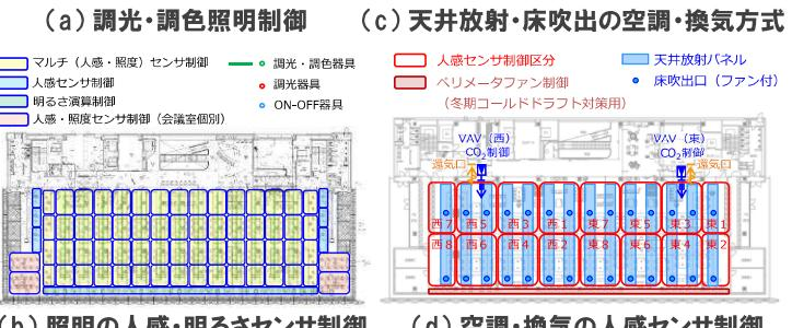
図9 照明・空調・換気の省エネルギー・ウェルネス制御
