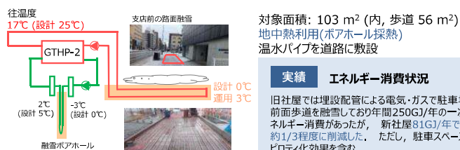
図8 地中熱を利用したロードヒーティング(路面融雪)
