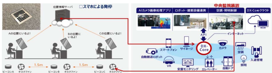
図-9 建物OS: DX-Core 概念図
