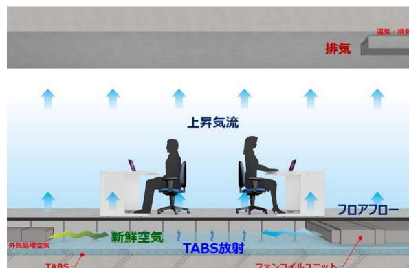
図-5 車体蓄熱放射型TABS+床吹出空調(アンビエント空調)
