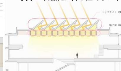
図-3 集光装置と配光装置
