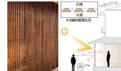
図-2 町家の木虫籠とその断面形状
