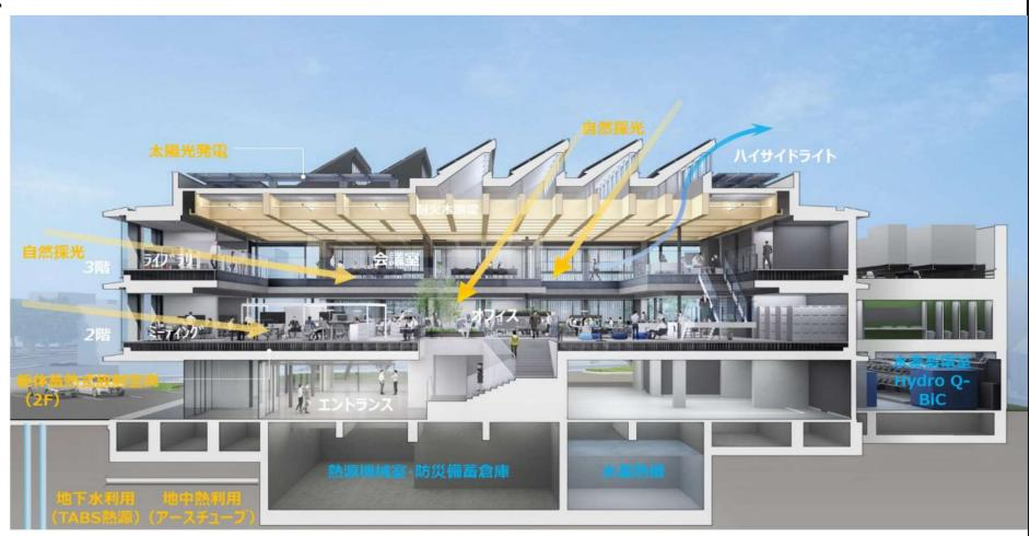
図-1 各種環境設備取組み断面図
