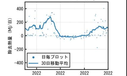
図-11 自然換気による除去熱量の時系列
