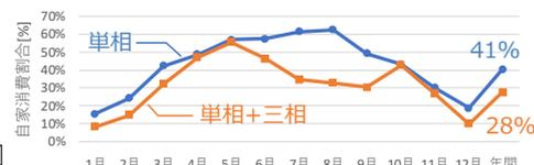
図6.6 PV発電電力の自家消費割合
