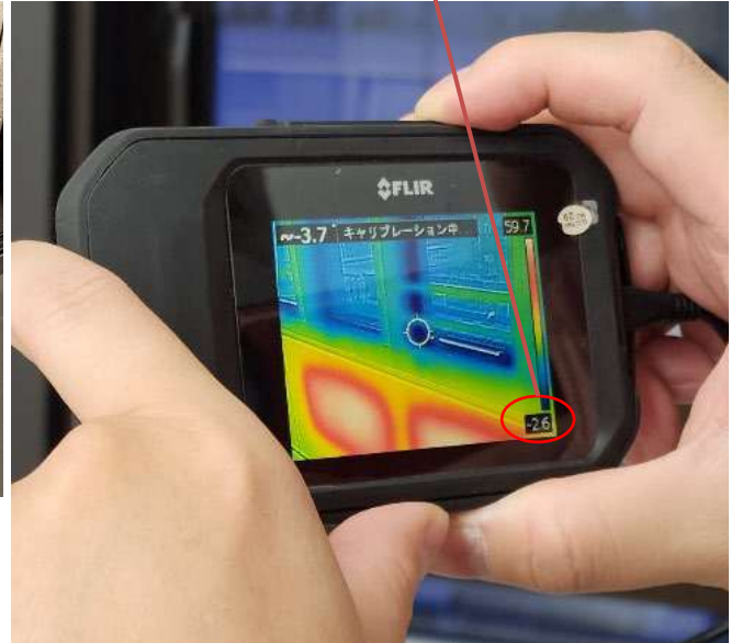
写真4-2. サーモカメラ画像（右下の温度表示：-2.6℃）
