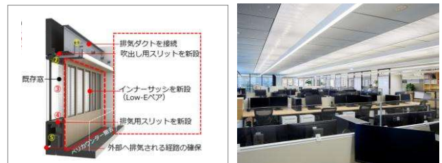
図4 排熱活用窓システム 写真2 薄型放射空調ダクト
