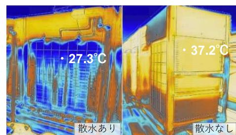
サーモカメラによる屋外機表面温度実測
