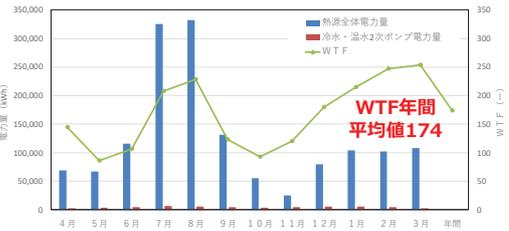
図21 冷水2次ポンプの水搬送システム効率
