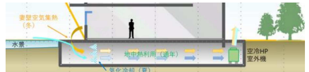
図-8 免震ピット利用空調イメージ
