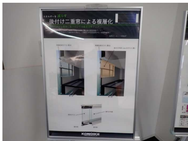
写真 3.5.4.3 後付け二重窓による複層化
